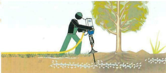
Mit Druckluft zwischen 5,0 bis 8,0 bar wird die Bodenverdichtung schonend und ohne Beschädigung des Wurzelwerkes behoben.
